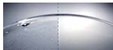
Обычное антизапотев. покрытие после 8 сек. | uvex ETC
